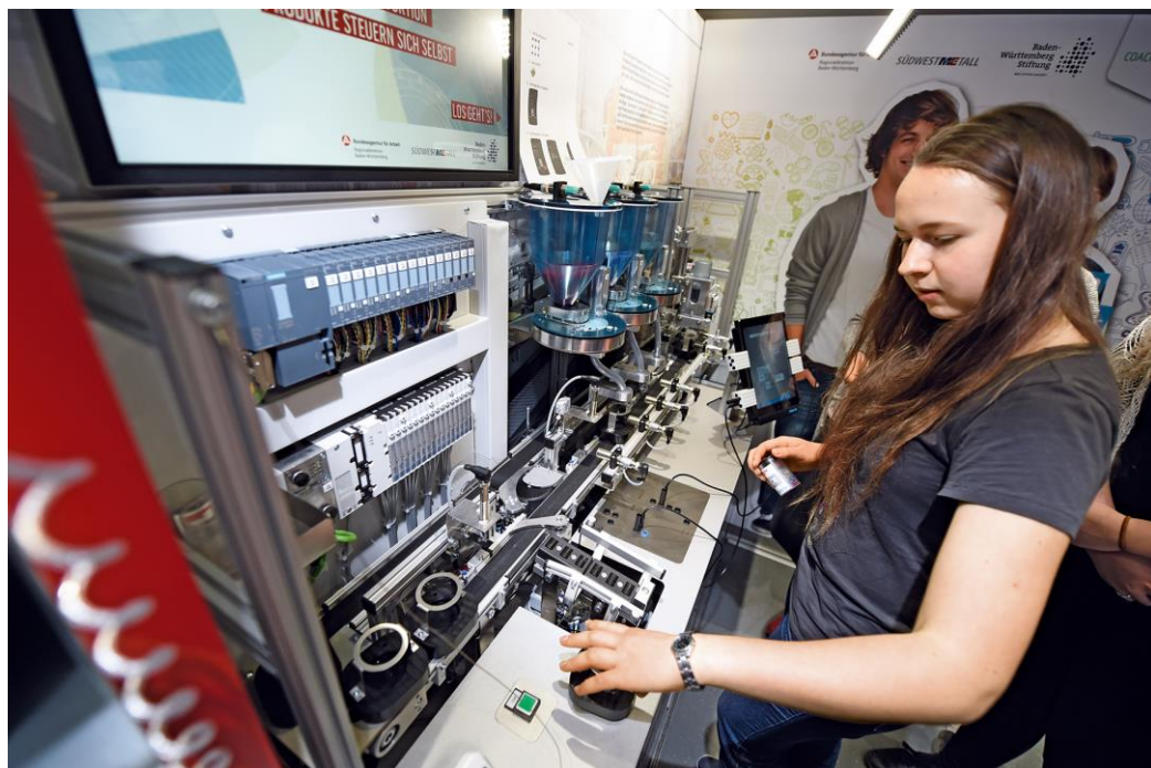
Bild 2: Die Arbeitsstationen im Truck werden fortlaufend an die Entwicklungen im Bereich Industrie 4.0 angepasst. So wie die Produktionsstraße, die mit dem Kommunikationsstandard IO-Link zur Visualisierung von Echtzeitdaten versehen wurde.
